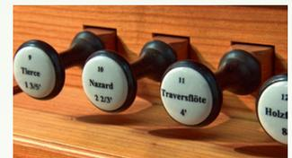
Registerzüge steuern die einzelnen Register an, Reihen von gleich gebauten und gleich klingenden Pfeifen.
