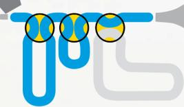
Funktion der Ventile im Bild: Drehventil
