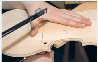
5 Auf die gleiche Weise erzeugt man auch die Decke der Violine. Hier werden noch die F-Löcher ausgesägt.
