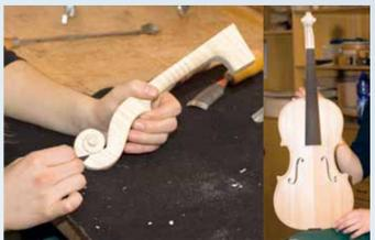
7 Den Hals mit der Schnecke formt man aus einem Stück Holz. Darauf wird das Griffbrett aus Ebenholz geleimt.
