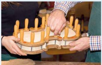
6 Boden, Zargen und Decke fügt man zum fertigen Korpus zusammen. Er verstärkt als ‚Resonanzkörper‘ den Klang der Saiten.
