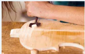
4 In mehreren Arbeitsgängen wird der Boden an der Ober- und Unterseite gewölbt ausgeformt und geglättet.
