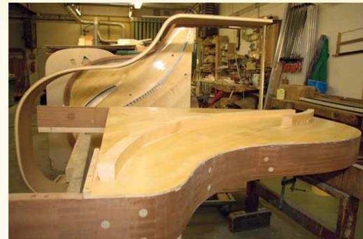
Der **Resonanzboden** aus dünnem Fichtenholz verstärkt den Klang der schwingenden Saiten.
