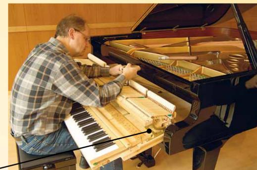
Die **Klaviatur** ist mit der Mechanik verbunden. Der Klavierbauer sorgt durch das Intonieren und Stimmen für einen gleichmäßigen und reinen Klang.
