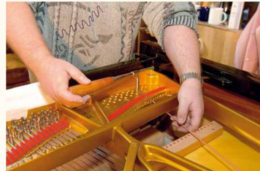
Die **Saiten** spannt man mit Hilfe der Stimmwirbel. Die tiefen Saiten sind mit Kupferdraht umwickelt.
