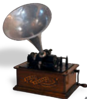
Bild 2: Edison-Phonograph mit Schalltrichter
